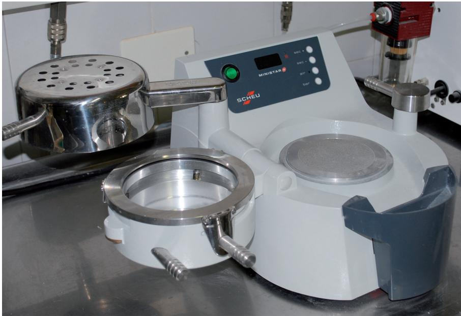
*Fig. 13* Termostampatrice. Il mercato offre una grande quantità di macchine termostampatrici, alcune delle quali con tecnologia digitale per un controllo ottimale dei valori di temperatura e sottovuoto
