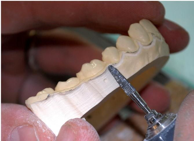
*Fig. 10* Al di sotto della linea precedentemente creata il gesso viene eliminato, rastremando le pareti e creando un'angolazione di circa 30°
